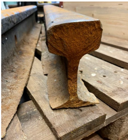
Abbildung 11-1: Korrosion am Schienenfuss
